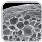
**TITAN EPS® von Brohlburg B-plus** ist ein graues Dämm-Material aus grafithaltigem expandiertem Polystyrol Hartschaum (EPS). Das Polystyrol-umschlossene Grafit wirkt dabei wie ein Spiegel, der die Wärmestrahlung durch den Schaumstoff reduziert. TITAN EPS® ermöglicht dadurch im Vergleich zu weißen Styropor® eine bis zu 20% geringere Dämmstärke und bis zu 50% Ressourceneinsparung bei gleicher Dämmwirkung.
