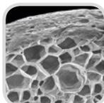
TiTAN EPS® von Brohlburg B-plus ist eine graue Dämmplatte aus grafithaltigem, expandiertem Polystyrol-Hartschaum. Das vom Polystyrol umschlossene Grafit in den Zellwänden der Perlen wirkt dabei wie ein Spiegel, der die Wärmestrahlung durch den Schaumstoff reduziert. Mit TiTAN EPS® von Brohlburg B-plus erzielt man im Vergleich zu weißem Styropor® eine bis zu 20% geringere Dämmstärke und bis zu 50% Ressourceneinsparung bei gleicher Dämmwirkung.
